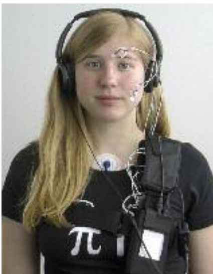
Anbringen der Elektroden für EMG, EDA und EKG vor dem User Experience Testing.
