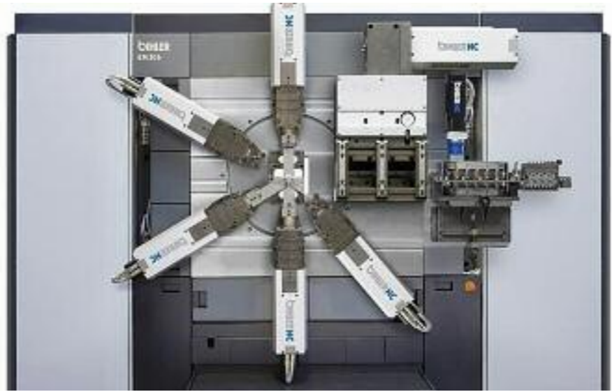
Stanz-Biege-Maschine für die Herstellung von Klemmen.
