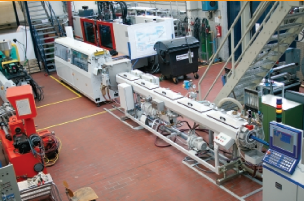
Die Rohrextrusionslinie an der Universität Paderborn ist etwa 16 Meter lang.
