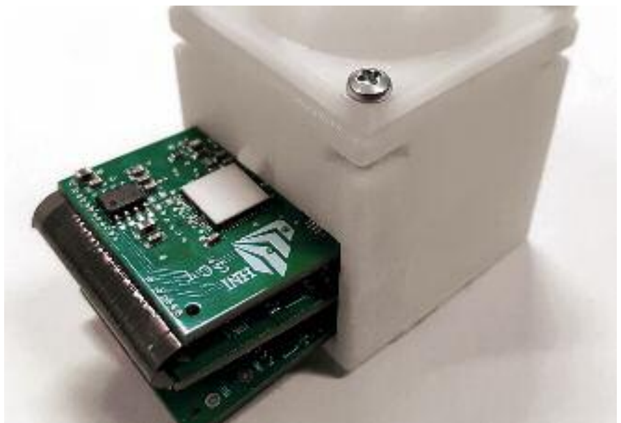
Miniatur-Radar-Modul in Starrflex-Technologie mit Gehäuse.
